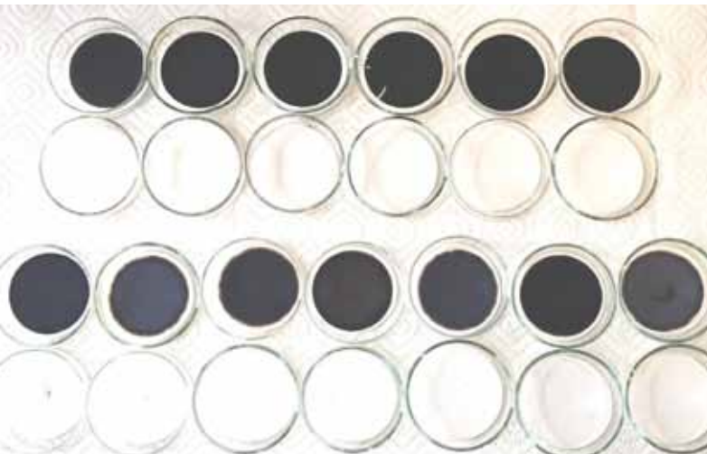
Filterproben im Holzfeuerungs-Abgas vor NoSmog [schwarze Filter] und danach [weiss]
