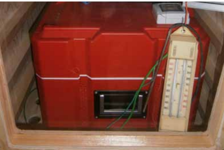
Powerbloxx im Schwitzkasten: Testreihe bei 35° C
