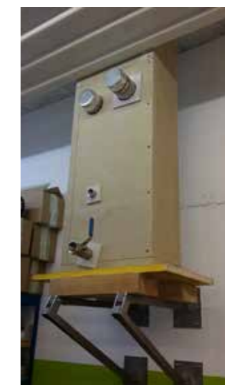
Nosmog-Prototyp für Holzfeuerungen mit bis zu 25 kW Leistung, der im Zuge des Nosmog-Projekts bei der OekoSolve AG in Plons (SG) gebaut wurde und seit Frühjahr 2016 in Betrieb ist. Oben im Bild die beiden Anschlüsse für die Lüftungsanlage. Unten der Ablauf für das (mit Staub gesättigte) Kondensat, das anschliessend über die Kanalisation entsorgt
