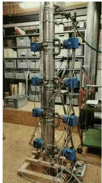
Eine der Pilotanlagen, die in das Kamin eingebaut werden können. Bild zvg
