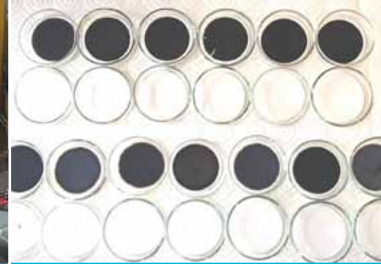
Filterproben im Holzfeuerungs-Abgas vor NOSMOG (schwarze Filter) und nach NOSMOG (weisse Filter)
